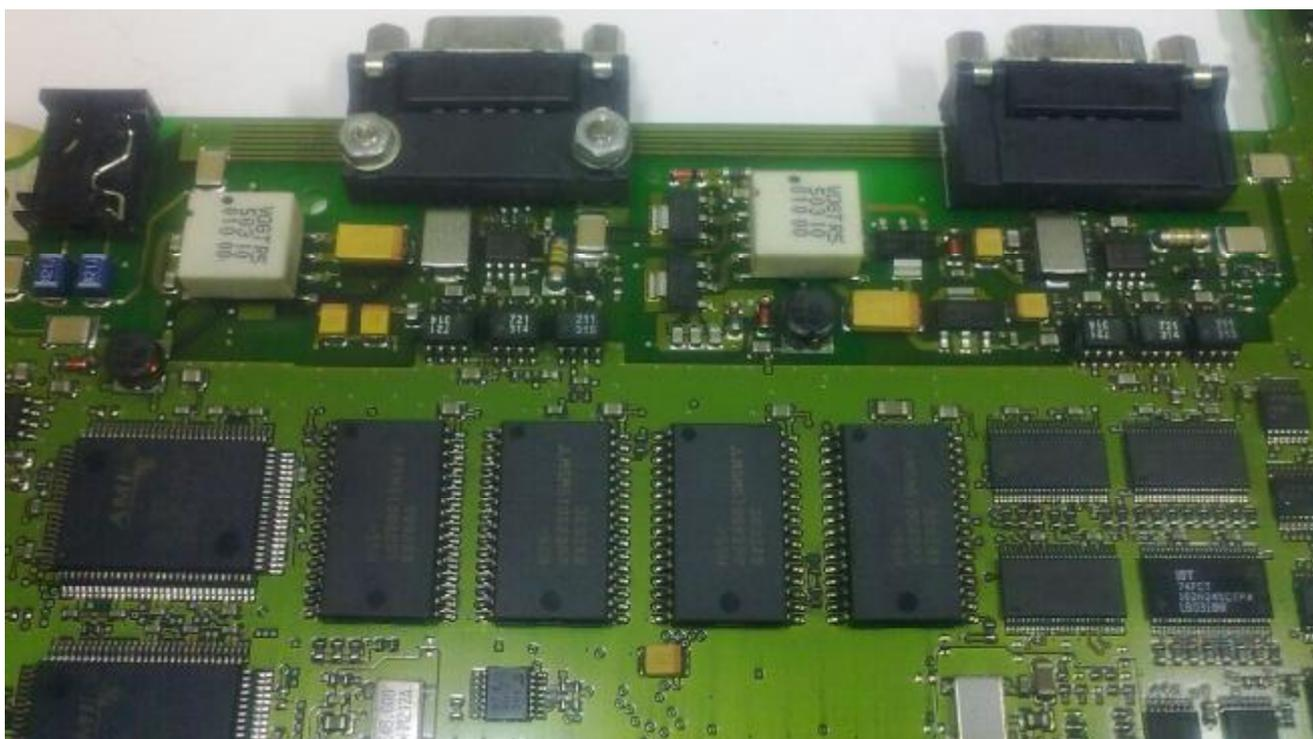
Теперь припаиваем все 9 ножек разъема к плате, используя ортофосфорную паяльную кислоту.
